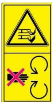
Obr. 4: Zákaz sahat rukou nebo šlapat nohou do pracovního prostoru žacího nože – nebezpečí pořezání.
