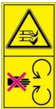
Obr. 3: Zákaz sahat rukou nebo šlapat nohou do pracovního prostoru rotačního válce – nebezpečí pořezání.
